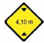
4,10 m Altura Limitada
